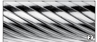
Diese Verzahnung liegt zwischen der Ausführung 1 und 3. Sie eignet sich besonders für Leichtmetalle, Bronze, Messing, Zinn, Zink, Kupfer und andere, leicht zu bearbeitende Werkstoffe. Für langspanige Werkstoffe sollte diese Verzahnung mit Spanbrechernuten eingesetzt werden.
