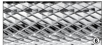
Mit dieser Universalverzahnung können fast alle Metallwerkstoffe, auch gehärtete und korrosionsbeständige Stähle, weitestgehend vibrationsarm bearbeitet werden. Es wird eine beachtliche Schnittleistung mit guter Oberflächengüte erreicht.
